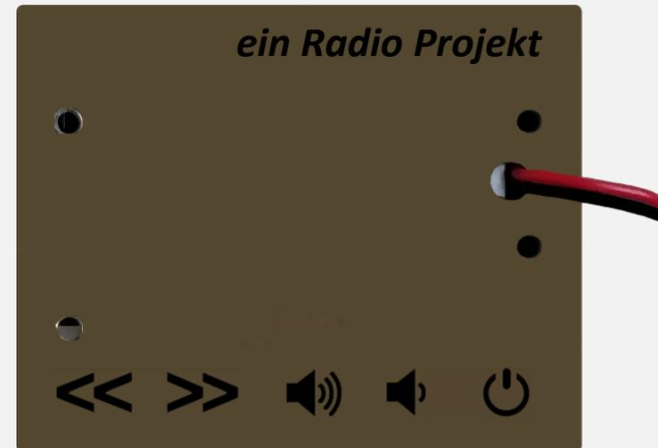
Die beiden Anschlussdrähte durch das grössere Loch führen und Batteriehalterung mittels doppelseitigem Klebeband auf der Rückseite des Frontplättchen kleben.
